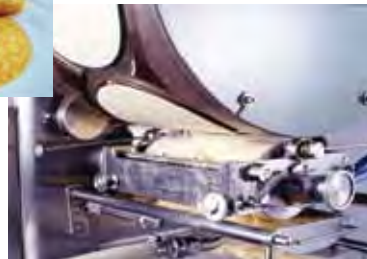
丸型クレープ (掘り込みドラム) Round crepe (On groove drum)
